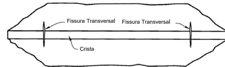
Figura 12 - Vista em planta de trinca transversal
